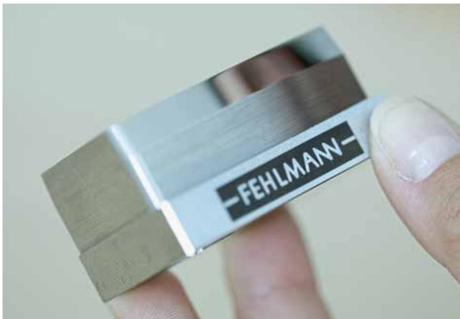
Oberflächengüten im Vergleich: unten gefräst mit Ra-Werten von 0,2, oben poliergeschliffen mit Ra-Werten von 0,02.
